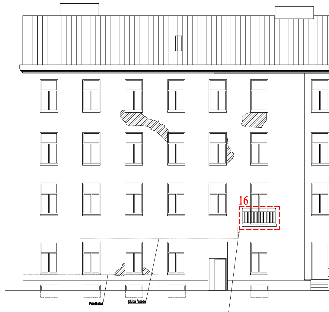
K-3. Balkono nr.16 kapitalinis remontas (demonuojamas esamas balkonas, įrengiamas naujas nekeičiant išvaizdos ir matmenų)
